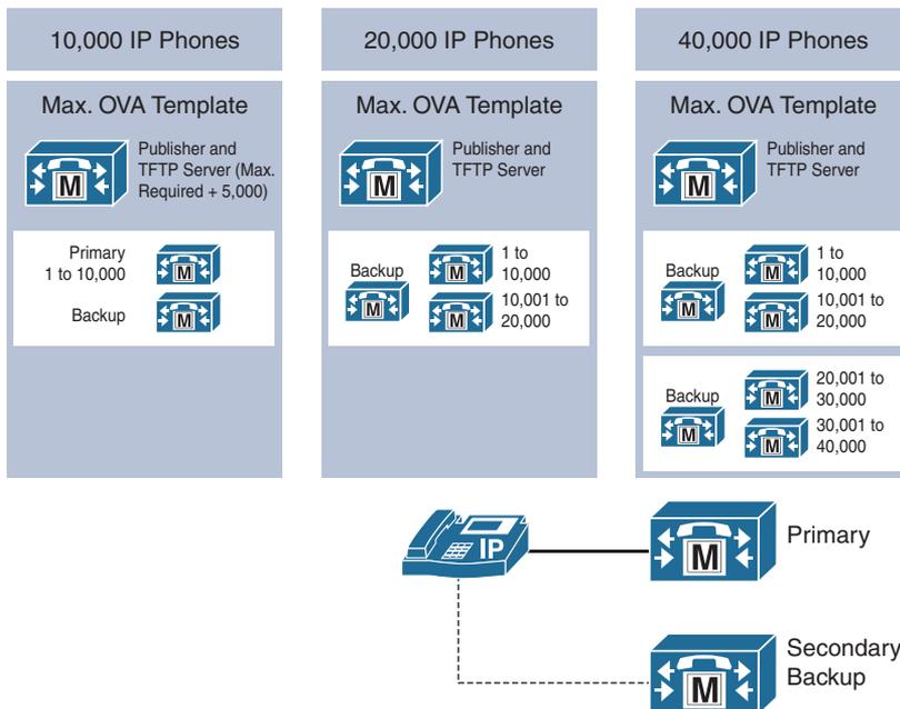
**Figure 2-12** 2:1 Redundancy Design
