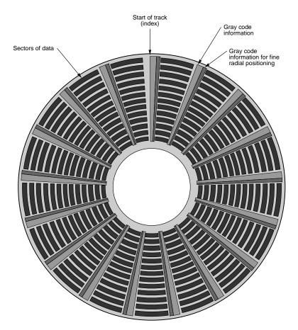
FIG. 12.9 An embedded servo.
